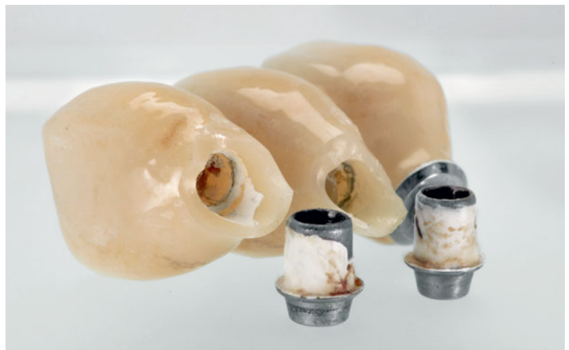
Abb. 1 Bruch der Krone durch zu kurze Klebebasen.
